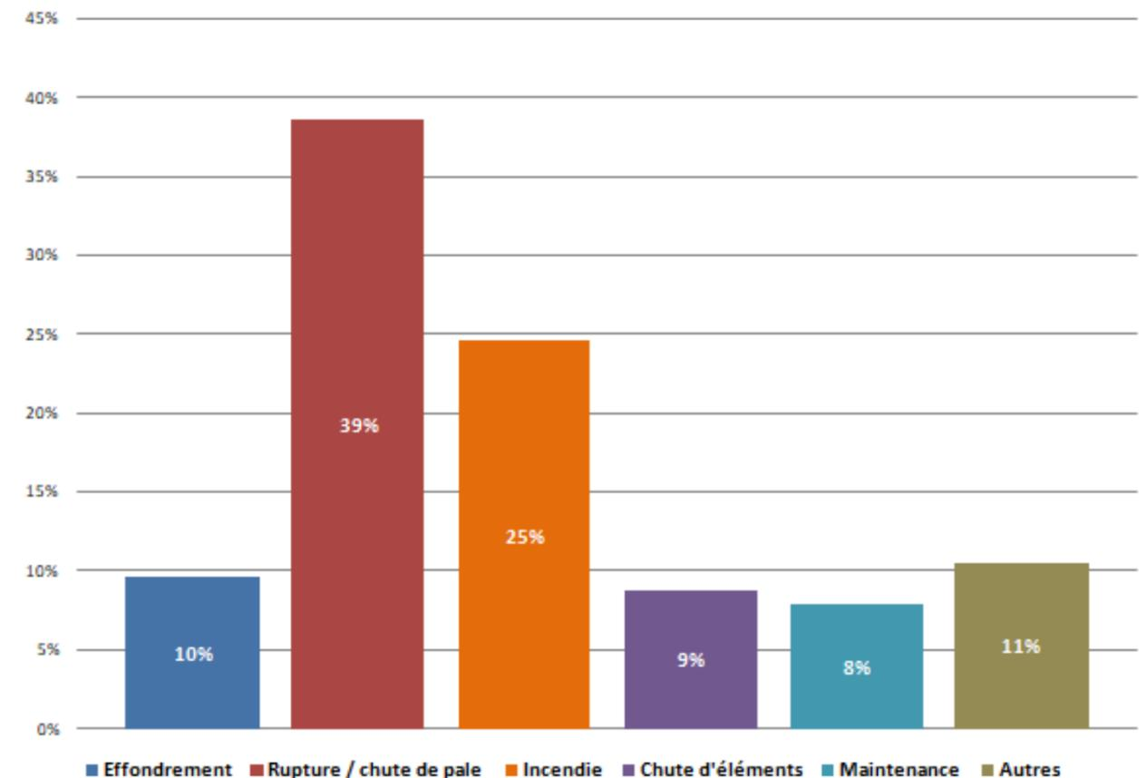
Figure 5 : Répartition des événements accidentels sur le parc éolien français entre 2000 et 2020
