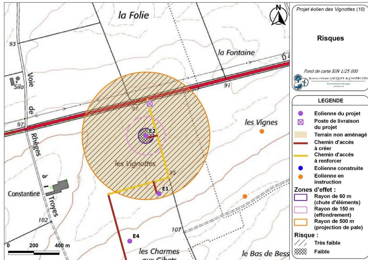
Carte 29 : Éolienne n°2 – Risques liés à l'effondrement de l'éolienne, à la chute d'élément de l'éolienne, et à la projection de pale ou de fragment de pale (Source : BE Jacquel et Chatillon)
