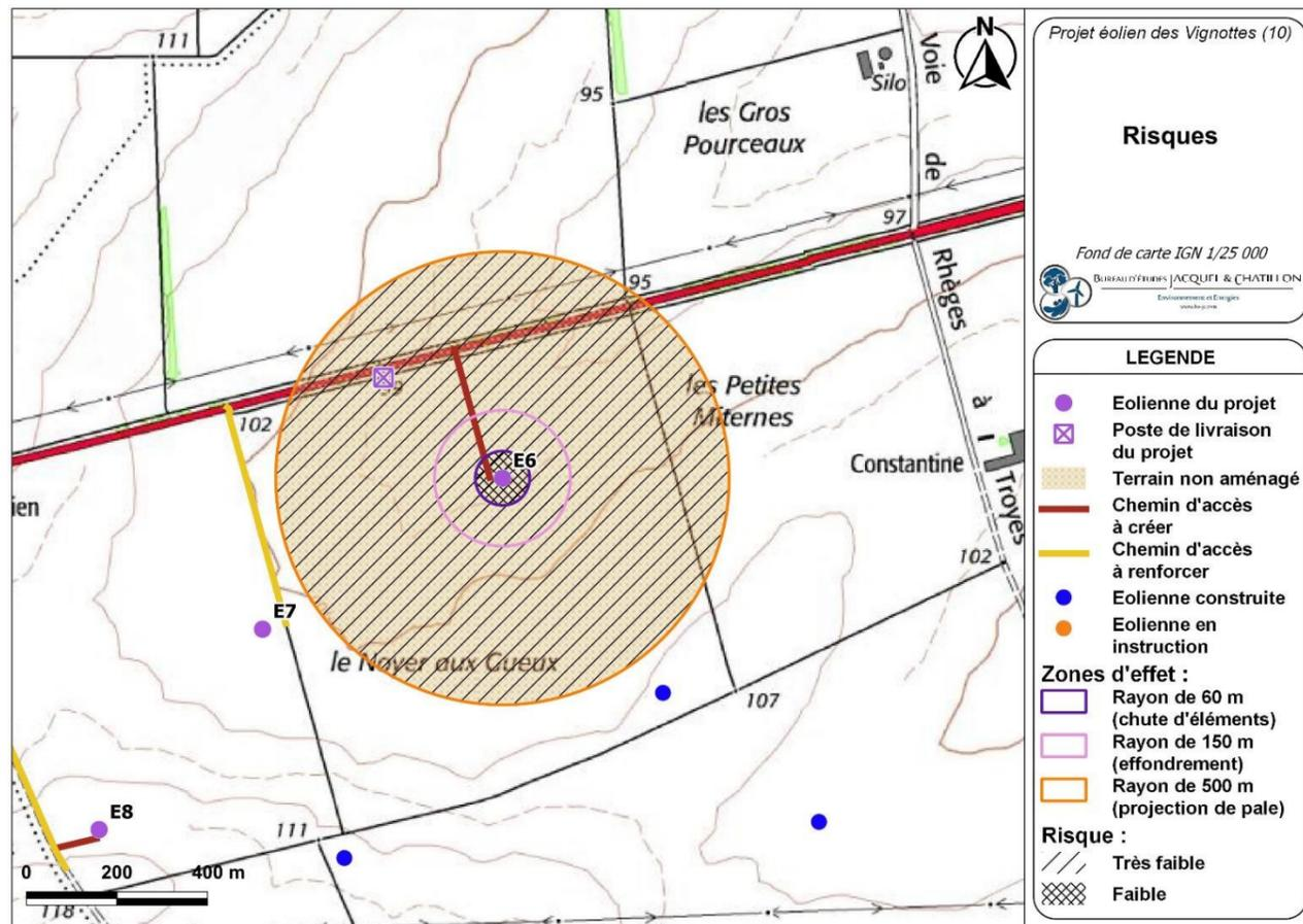
Carte 35 : Éolienne n°6 – Risques liés à l'effondrement de l'éolienne, à la chute d'élément de l'éolienne, et à la projection de pale ou de fragment de pale (Source : BE Jacquel et Chatillon)
