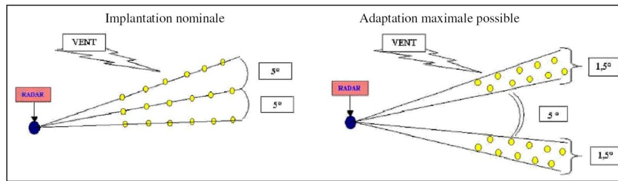
Figure 1 : Préconisations d'implantation du ministère des Armées en zone de coordination du radar de Prunay-Belleville (Source : Direction de la Sécurité Aéronautique d'Etat)
