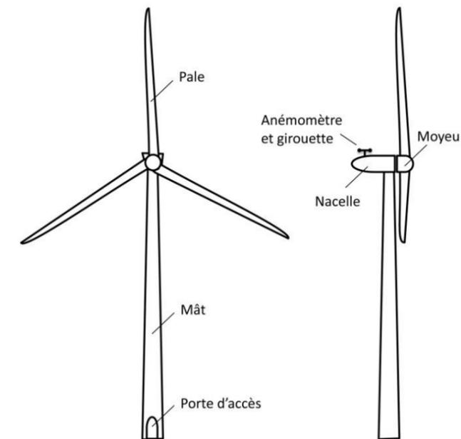
Figure 2 : Schéma simplifié d'un aérogénérateur (Source : INERIS)
