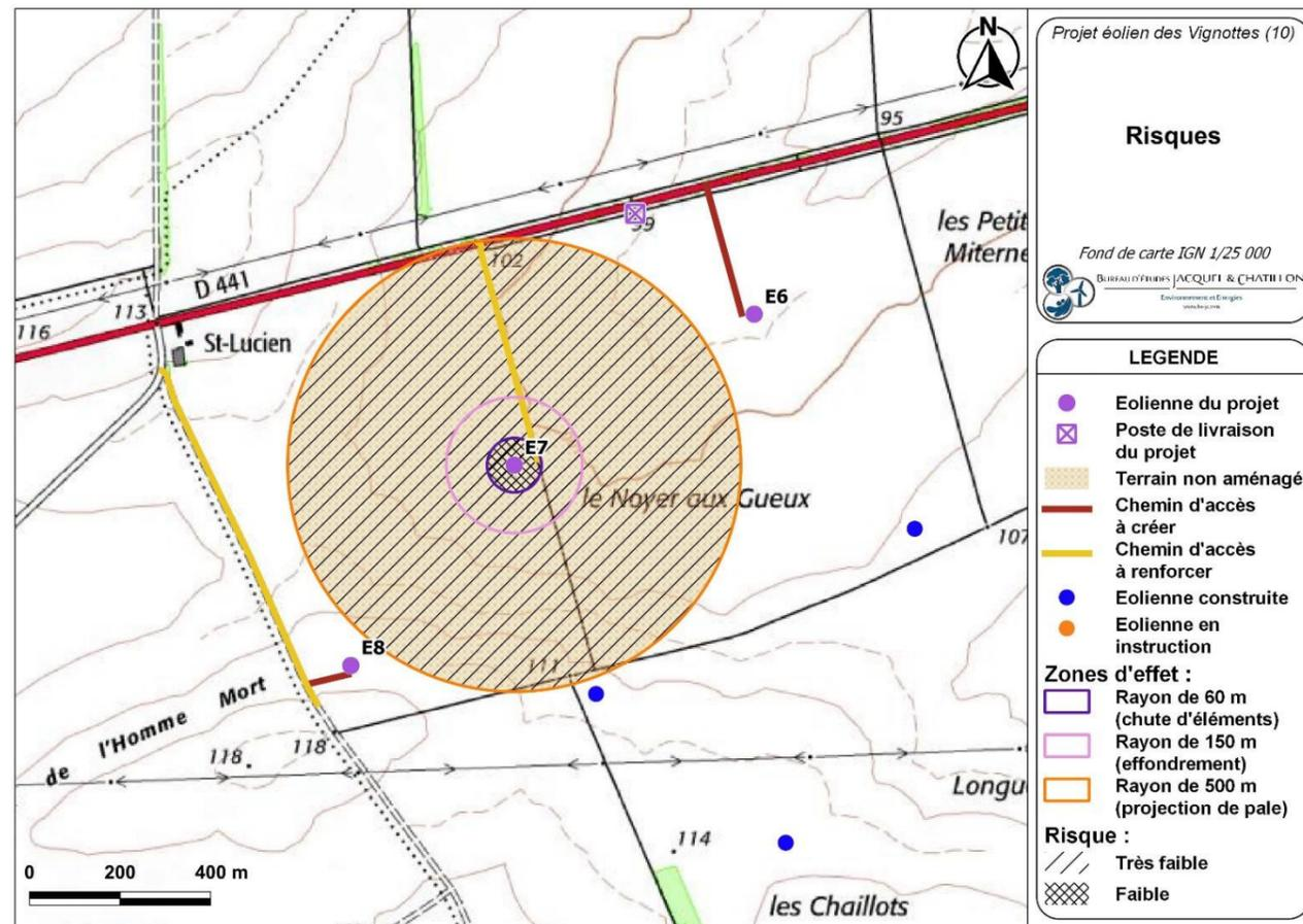
Carte 37 : Éolienne n°7 – Risques liés à l'effondrement de l'éolienne, à la chute d'élément de l'éolienne, et à la projection de pale ou de fragment de pale (Source : BE Jacquel et Chatillon)
