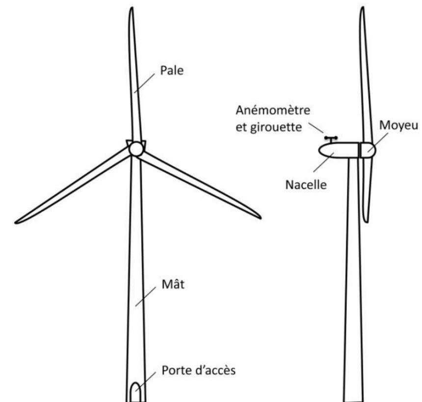
Figure 1 : Schéma simplifié d'un aérogénérateur (Source : INERIS)
