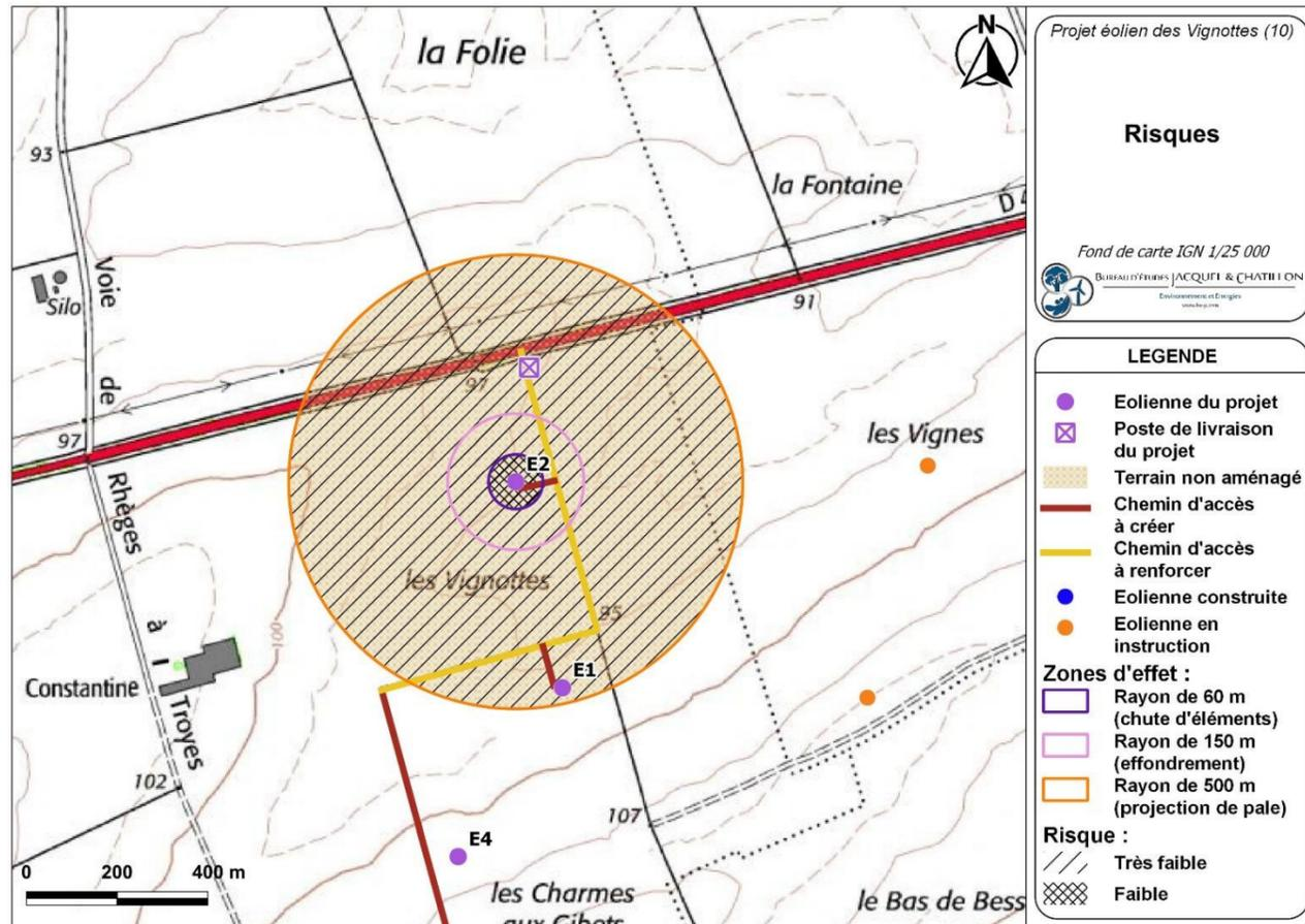
Carte 19 : Éolienne n°2 – Risques liés à l'effondrement de l'éolienne, à la chute d'élément de l'éolienne, et à la projection de pale ou de fragment de pale (Source : BE Jacquiel et Chatillon)
