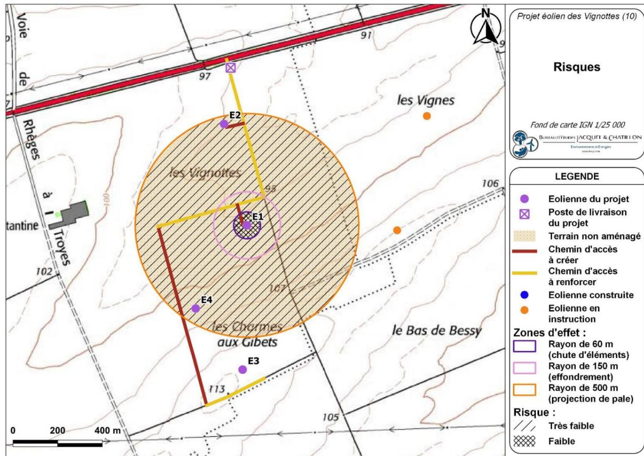
Carte 17 : Éolienne n°1 – Risques liés à l'effondrement de l'éolienne, à la chute d'élément de l'éolienne, et à la projection de pale ou de fragment de pale (Source : BE Jacquiel et Chatillon)
