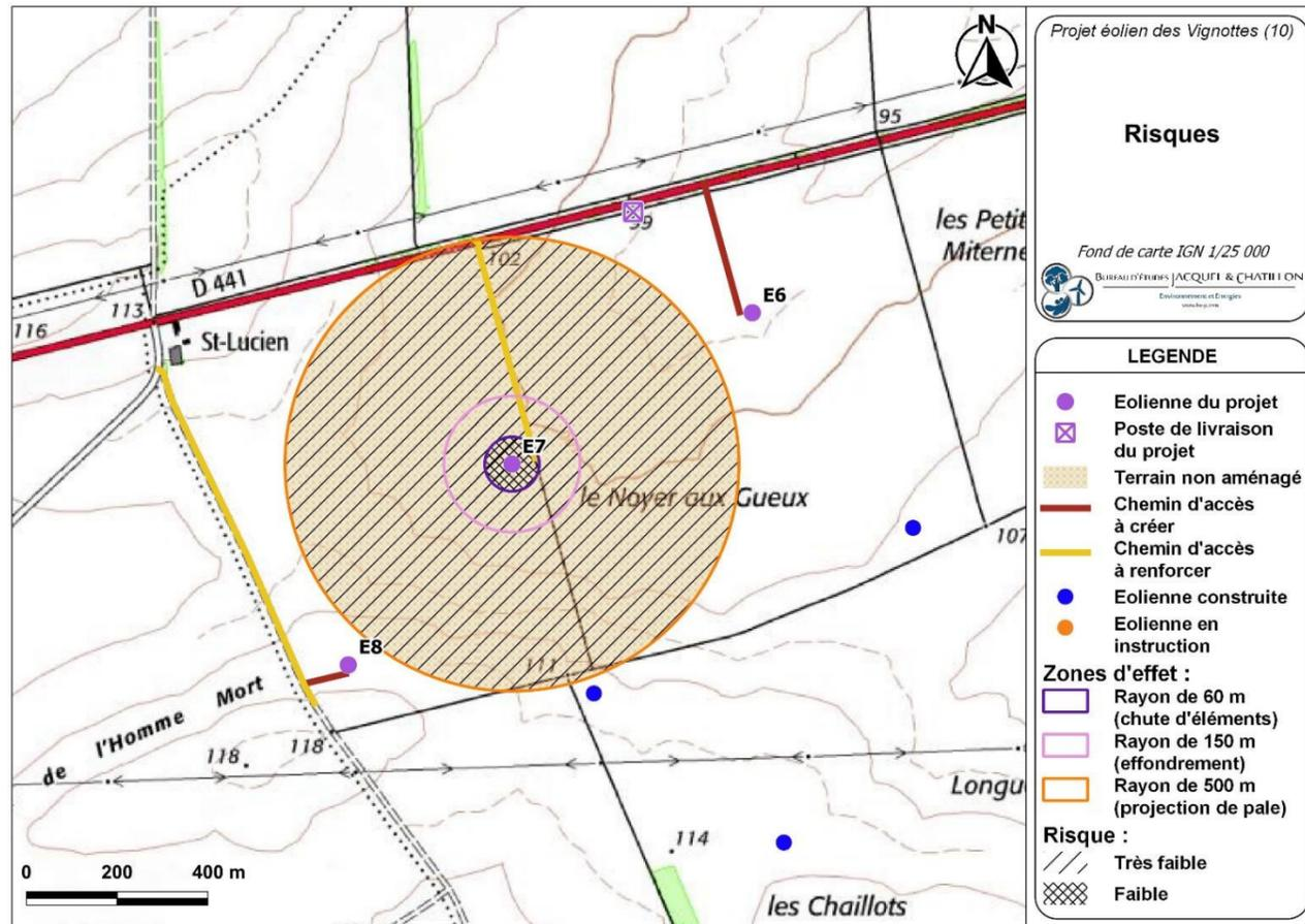
Carte 27 : Éolienne n°7 – Risques liés à l'effondrement de l'éolienne, à la chute d'élément de l'éolienne, et à la projection de pale ou de fragment de pale (Source : BE Jacquel et Chatillon)
