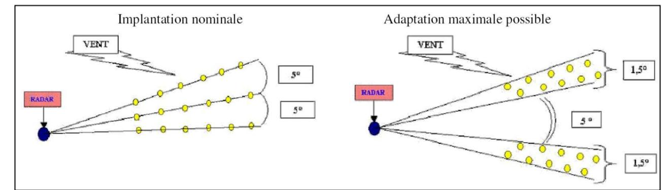
Figure 3 : Préconisations d'implantation du ministère des armées en zone de coordination du radar de Prunay-Belleville (Source : Direction de la Sécurité Aérienne d'Etat)
