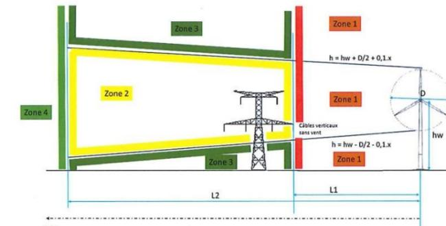
$L1 = hw + D/2 + d$  (distance en mètres) avec  $d = 3m$  (distance de garde)
