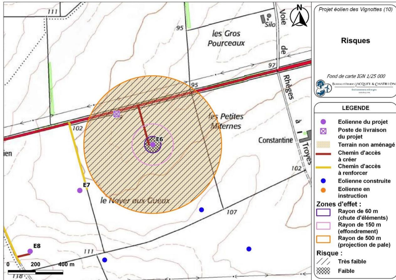
Carte 25 : Éolienne n°6 – Risques liés à l'effondrement de l'éolienne, à la chute d'élément de l'éolienne, et à la projection de pale ou de fragment de pale (Source : BE Jacquiel et Chatillon)
