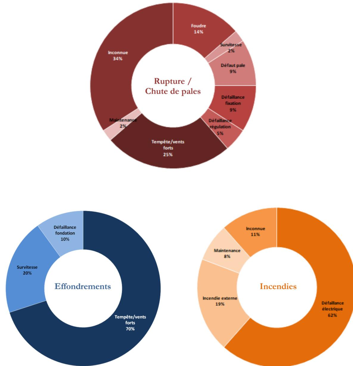
Figure 6 : Répartition par cause des principaux événements accidentels sur le parc éolien français entre 2000 et 2020
