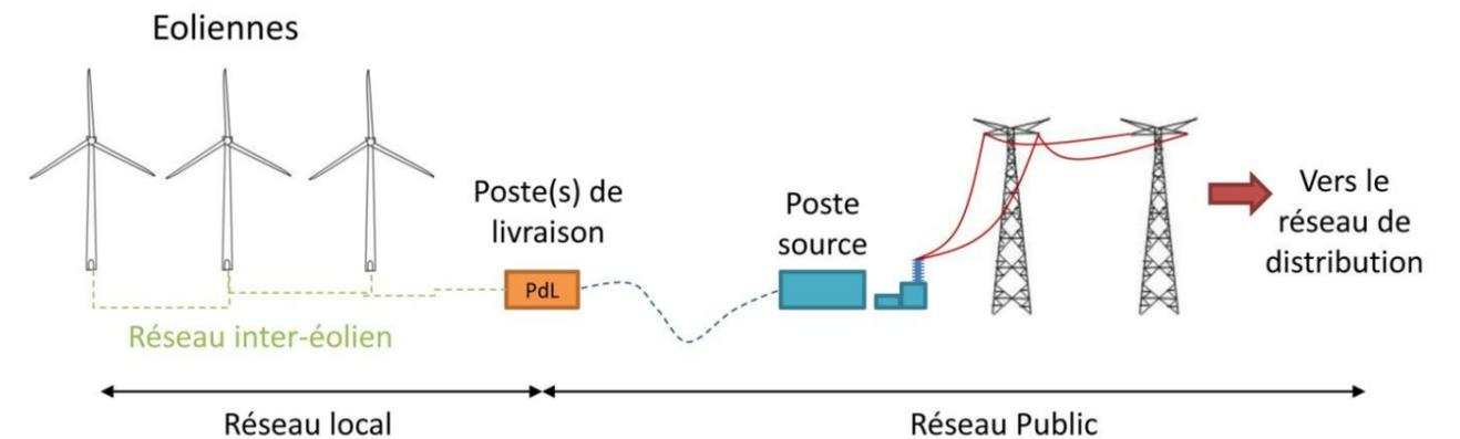
Figure 4 : Raccordement électrique des installations (Source : INERIS)
