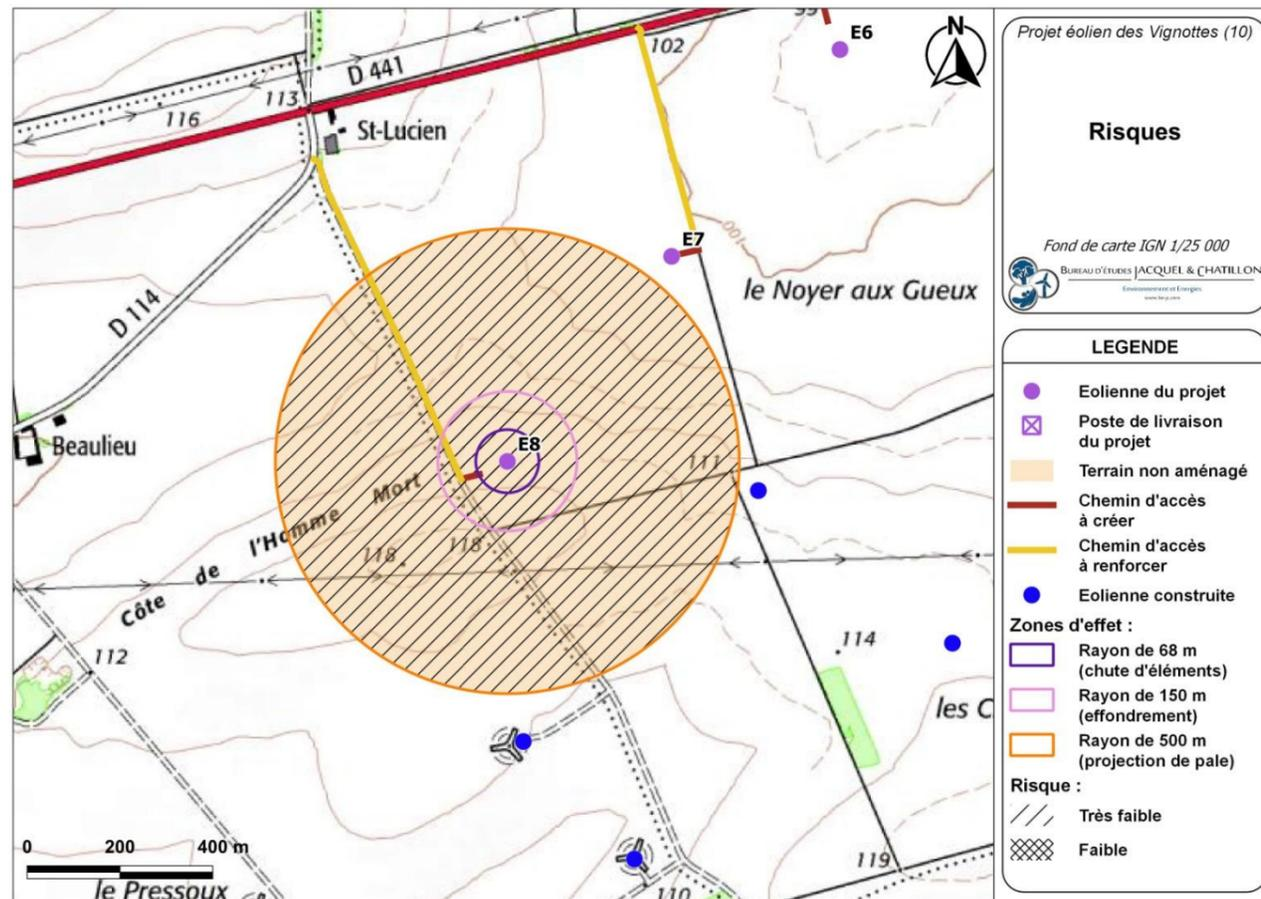
Carte 39 : Éolienne n°8 – Risques liés à l'effondrement de l'éolienne, à la chute d'élément de l'éolienne, et à la projection de pale ou de fragment de pale (Source : BE Jacquel et Chatillon)
