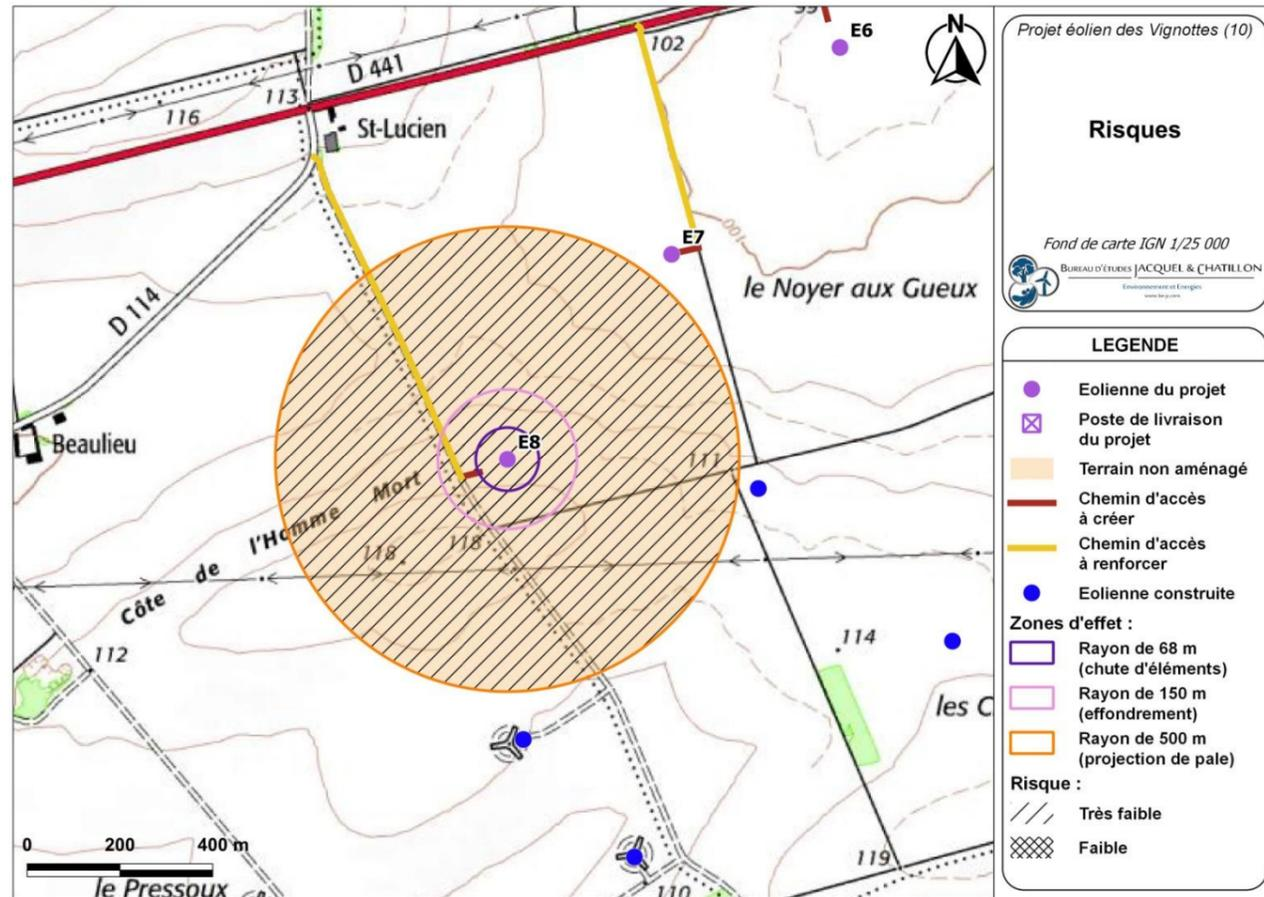
Carte 29 : Éolienne n°8 – Risques liés à l'effondrement de l'éolienne, à la chute d'élément de l'éolienne, et à la projection de pale ou de fragment de pale (Source : BE Jacquel et Chatillon)
